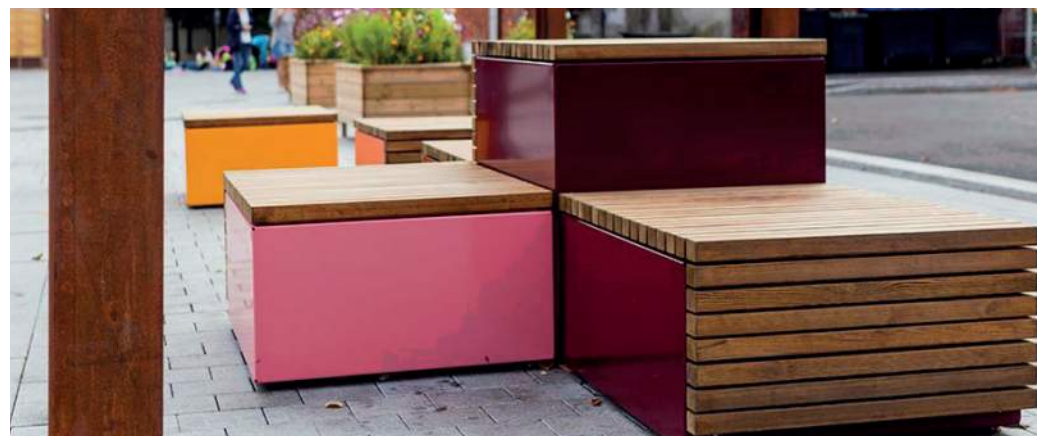
Höjdskillnaden byggs upp av L-stöd och block i trä, metall. De kan kompletteras med plantering och belysning.
