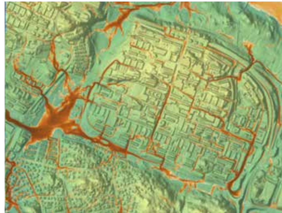
Beräknade vattendjup vid ett klimatanpassat 100-årsregn (till vänster) och beräknade vattenflöden (till höger) enligt Stockholms stads skyfallsmodell (2024).
