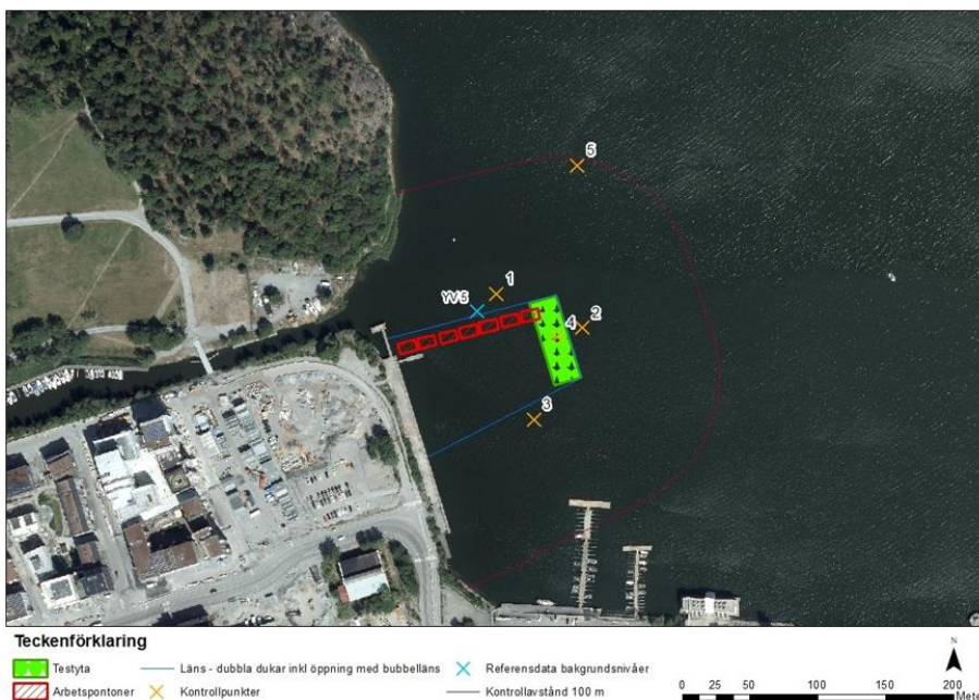
Figur 68. Arbetsområdet, grumlingskydd och provpunkter för mätning av pH och turbiditet. Från (Peab, 2022).
