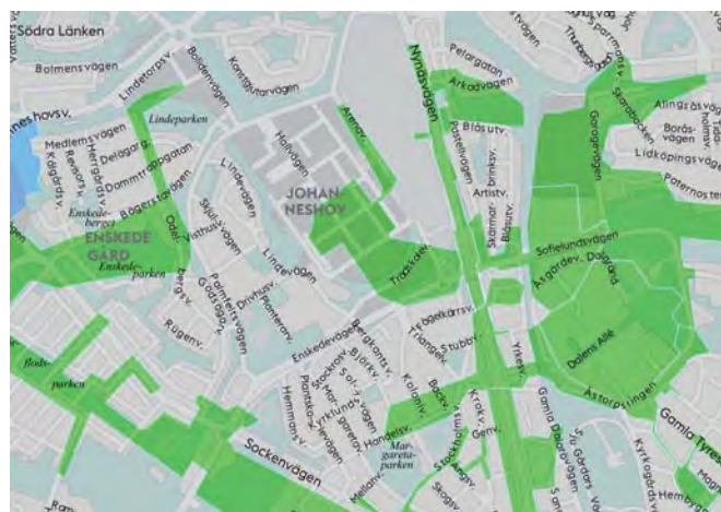
Grönmarkerat område visar det område vars dagvatten som idag leds till Östbergatunneln. Resterande gråmarkerade ytor leds via kombinerat system till Henriksdals reningsverk.
